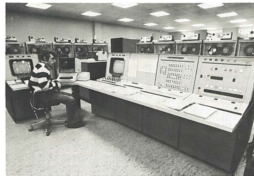
Fig. 4. Datasentrets hovedpanel for overvåking av feltinstallasjoner og data. På skjermen til høyre kan en følge de seismiske registreringene, skjermen til venstre viser den seismiske aktivitet som lysende punkter på et verdenskart, alt i sann tid. I bakgrunnen båndstasjoner.
