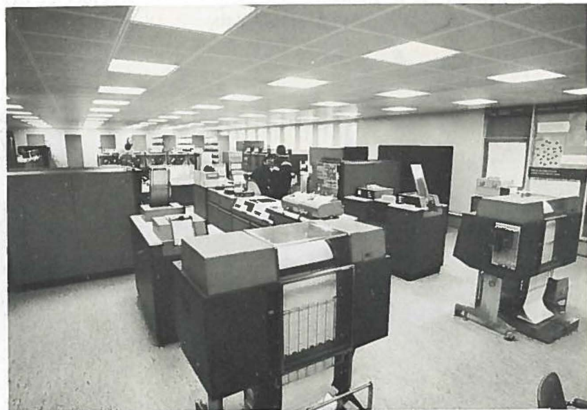
Fig. 3. Interiør fra datasentret på Kjeller. I forgrunnen linjeskrivere, kortlesere og kurveskrivere, sentralt og vendt mot hverandre de to datamaskiner, i bakgrunnen skimtes båndstasjoner og hyller med magnetbånd.
