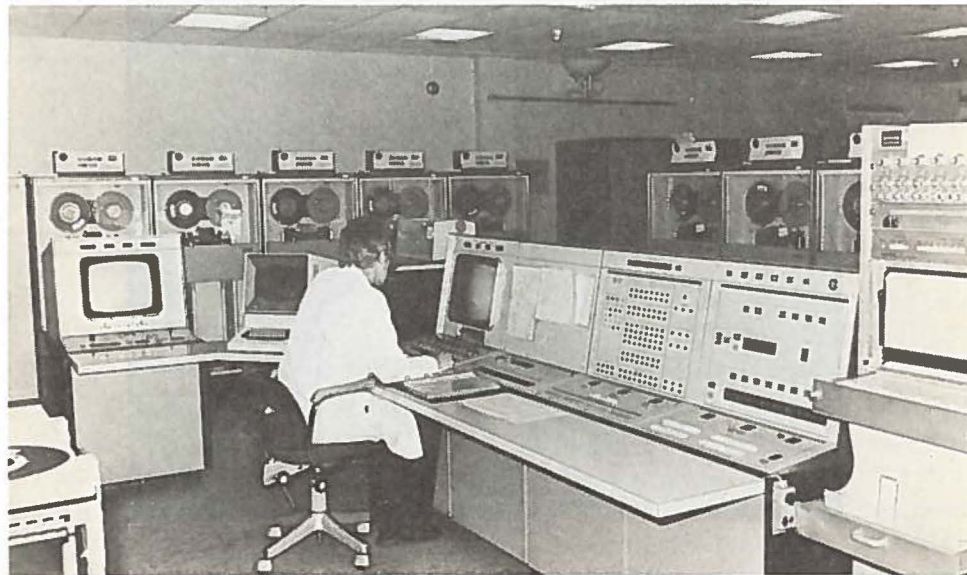
Fig. 2 Datasenterets hovedpanel for overvåking av feltinstallasjoner og data. Fra dette panelet kan operatøren følge de seismiske registreringer i sann tid, og i tillegg kontrollere at feltinstrumentene fungerer tilfredsstillende.
