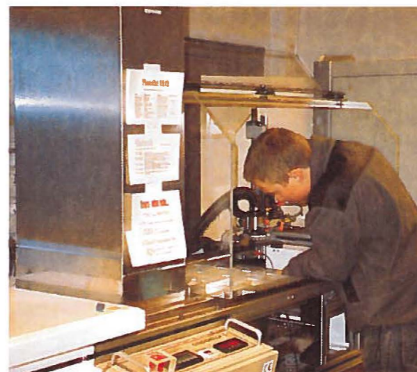
En målestasjon for radioaktivitet i luft er etablert på Platåberget i Longyearbyen. Stasjonen inngår i nettverket for overvåking av prøvestansavtalen. Bildet viser enheten for innsugning (600 m 3 /time) og filtrering av luft.
